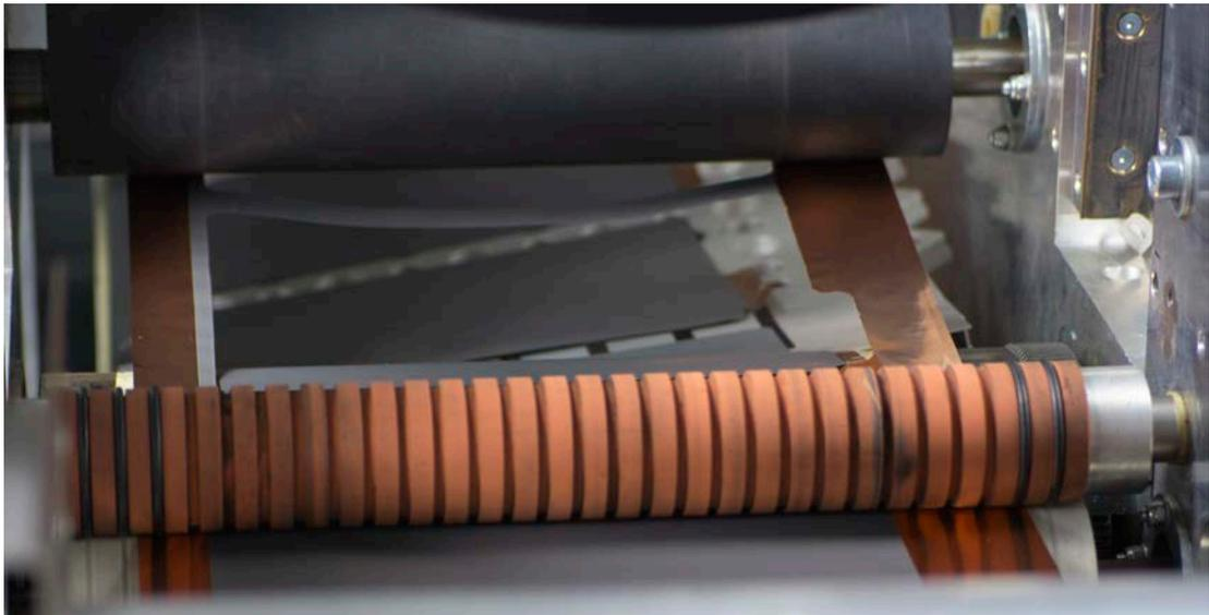
Elektrodenkonfektionierung mit Laser „on the fly“
